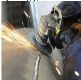
Hình 3: Mối hàn kim loại đang được mài nhẵn.
